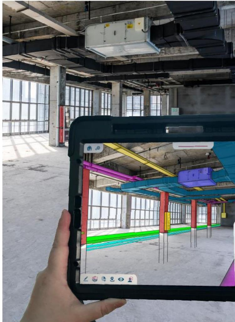
GENIEVISION propose d'afficher les plans 3D d'usines ou d'installations industrielles superposés en 3D grâce à la réalité augmentée
