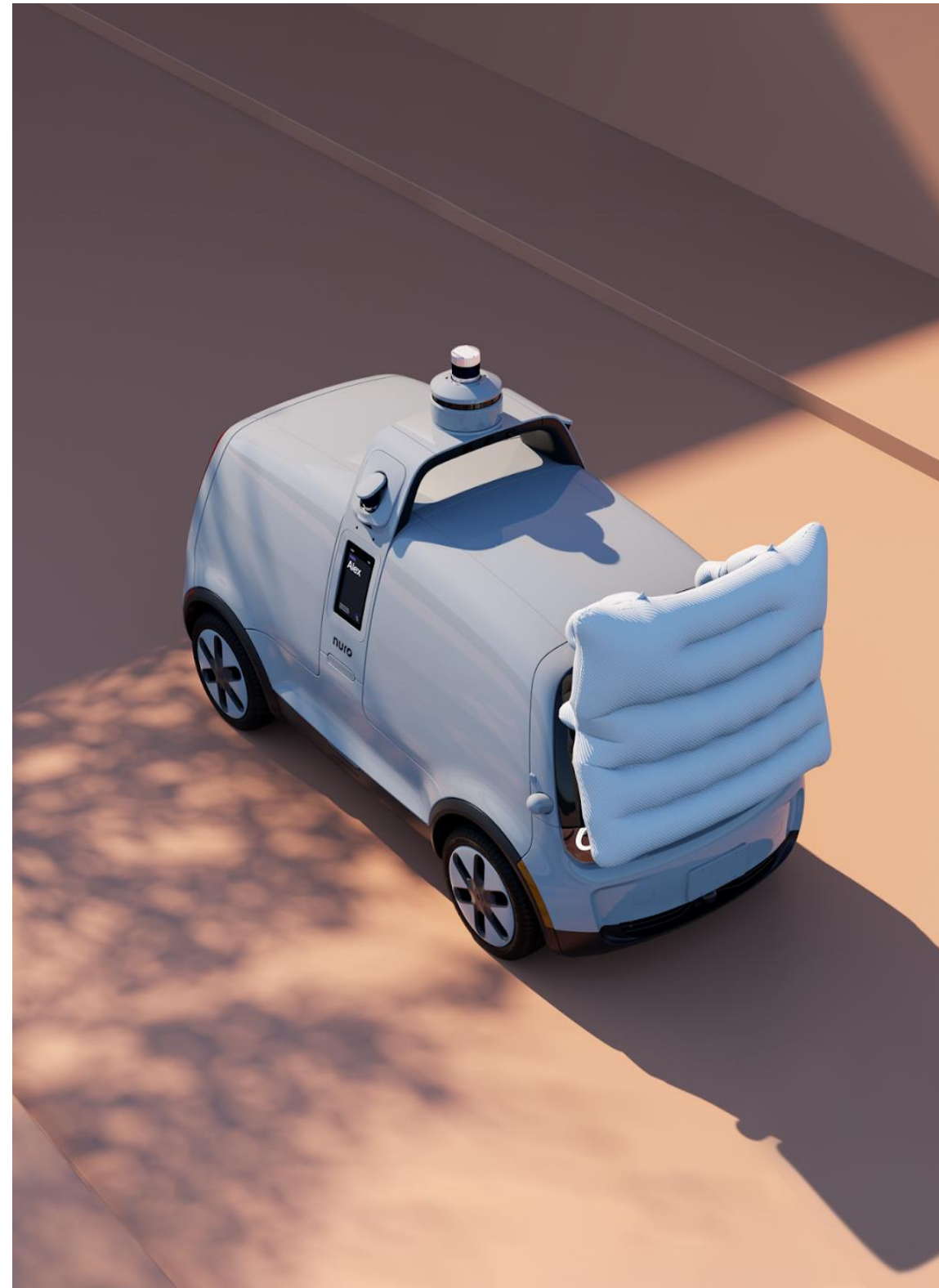
Nuro Véhicule de livraison autonome de 3ème génération avec airbags
