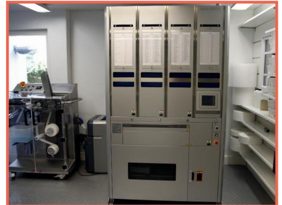
Parcours type d'une PDA sécurisée : extraction du médicament de son emballage d'origine par une débitriceuse (à gauche), placement dans des boîtes stériles (à droite) réintroduction dans le robot et conditionnement personnalisé au nom du patient.
